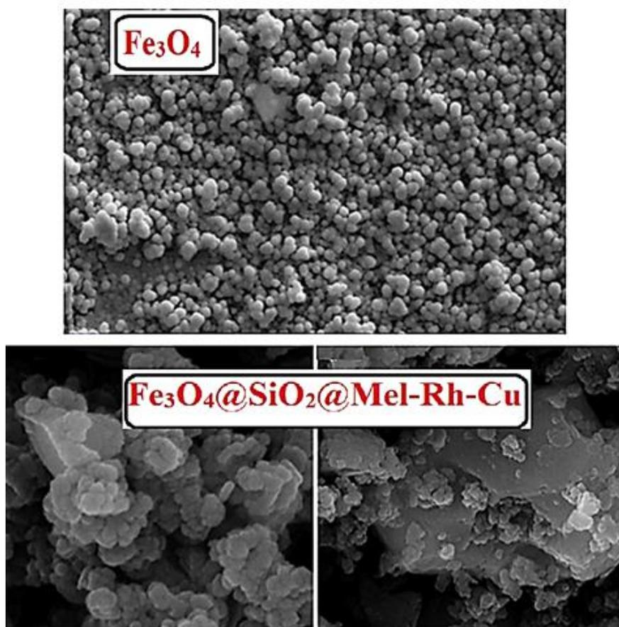
**Figure 4:** SEM analysis of  $\text{Fe}_3\text{O}_4$  and  $\text{Fe}_3\text{O}_4@SiO_2@Mel-Rh-Cu$
