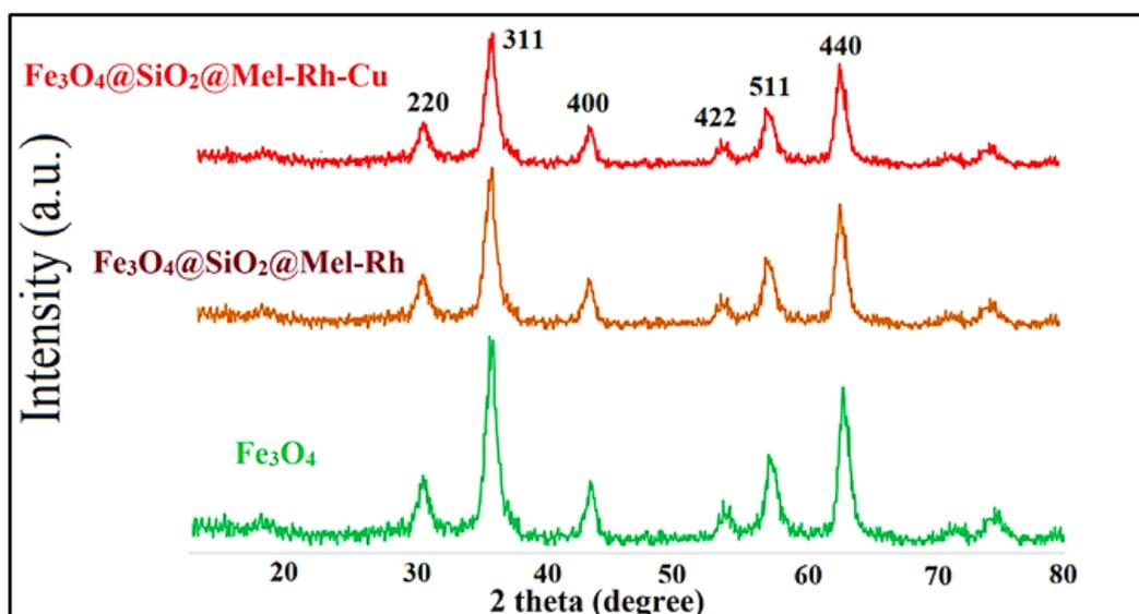
**Figure 3:** XRD patterns of  $\text{Fe}_3\text{O}_4$ ,  $\text{Fe}_3\text{O}_4@SiO_2@Mel-Rh$  and,  $\text{Fe}_3\text{O}_4@SiO_2@Mel-Rh-Cu$
